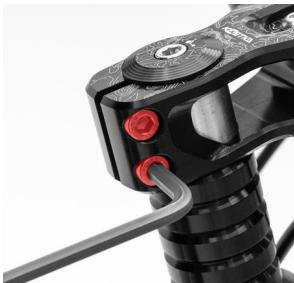
Řídítka srovnejte s předním kolem tak, že osa symetrie říditek je rovnoměrná s předním kolem a poté dotáhněte **šrouby** na představci (max. 8 - 9 Nm).
