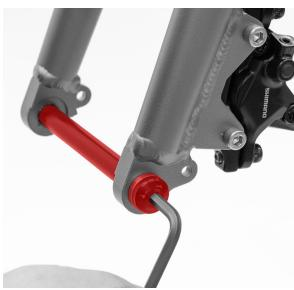
Povolte pevnou osu předního kola a vysuňte ji.
