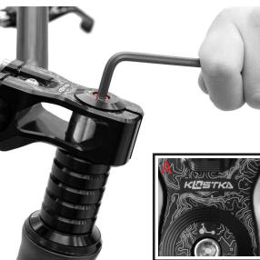
Nasad'te zpět víčko hlavového složení a dotáhněte šroub (max. 5 - 6 Nm) tak, aby v hlavovém složení nevznikala vůle a koloběžka na víčku byla srovnaná s logem (viz obrázek A). Na šroub poté nasad'te krytku.
