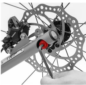
Vložte kolo do zadní vidlice. **Pevnou osu vsuňte** do náboje skrz vidlici a dotáhněte (max. 7 - 10 Nm). Kolo musí být symetricky umístěno mezi rameny vidlice, kolo ve správném směru rotace a brzdný kotouč přesně mezi čelistmi zadní brzdy.
