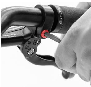
Nastavte brzdové páky do vhodné polohy tak, aby se vám snadno ovládaly a dotáhněte **šrouby** (max. 5 - 6 Nm) na objímce.
