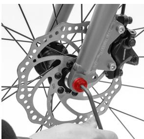
Vložte kolo do přední vidlice. Pevnou osu vsuňte do náboje skrz vidlici a dotáhněte (max. 7 - 10 Nm). Kolo musí být symetricky umístěno mezi rameny vidlice, kolo ve správném směru rotace a brzdný kotouč přesně mezi čelistmi zadní brzdy.
