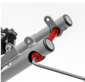
Povolte pevnou osu zadního kola a vysuňte ji.
