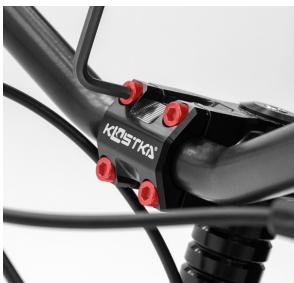
Povolte **šrouby na představci**. Srovnejte řídítka do vhodné polohy a **šrouby** dotáhněte (max. 8 - 9 Nm). Pozn.: Šrouby dotahujte postupně do kříže proti sobě všechny stejným dotahovacím momentem.
